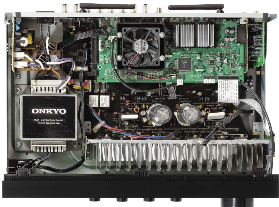
Z pracą końcówek w klasie G wiąże się rozbudowana sekcja zasilająca.
